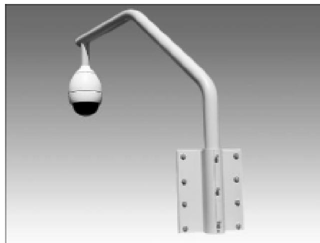
Эти кронштейны предназначены для систем типа AutoDome весом до 29 кГ. Крепление кронштейна осуществляется на крышный парапет (изнутри или снаружи) или стену. Для монтажа на горизонтальную поверхность крыши применяется адаптер LTC 9230/01. Для удобства обслуживания и монтажа, кронштейн может поворачиваться в креплении фланца.
