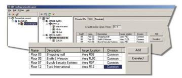
Конфигурация модели двери управления лифтом Эта функция позволяет сконфигурировать и использовать модель двери "лифт", управлять 56 этажами на каждый считыватель в кабине лифта. Вы можете определить доступ к этажам, который может быть назначен владельцам карточки подобно стандартным разрешениям на доступ. Число контролируемых этажей зависит от типа контроллера системы управления доступом, используемого в системе.
