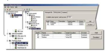
Диалог для управления автомобильной стоянкой Эта функция позволяет определять и использовать модель двери "автомобильная стоянка", которая содержит средства управления двумя шлагбаумами для въезда и выезда и назначенным светофором, который показывает состояние автостоянки.
