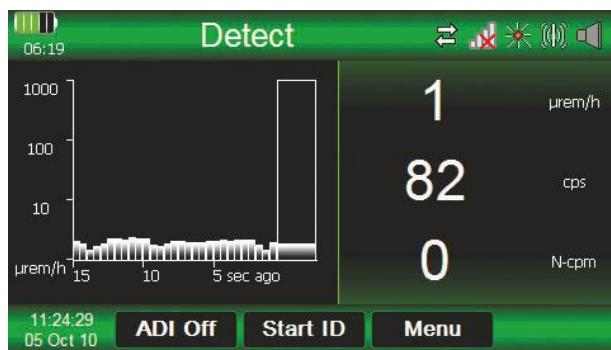
На дисплее отображается график изменения интенсивности излучения источника. Справа от графика на каждом экране постоянно отображаются скорость распада и мощность дозы излучения в реальном времени, предоставляя пользователю необходимую информацию в любое время.
