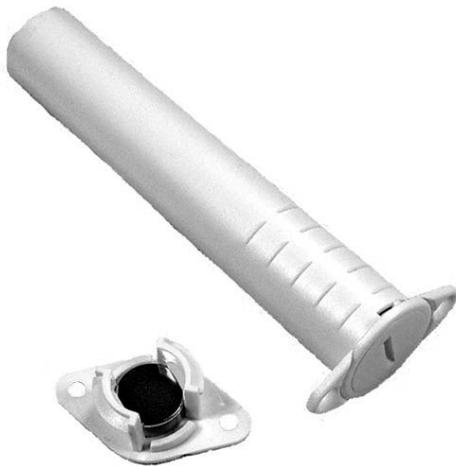
Дверные и оконные контакты wLSN для утепленного монтажа представляют собой магнитные герконы для наблюдения за дверьми и окнами. Они имеют внутренние герконы, активируемые внешним магнитным устройством. Они имеют также встроенный тампер крышки.
