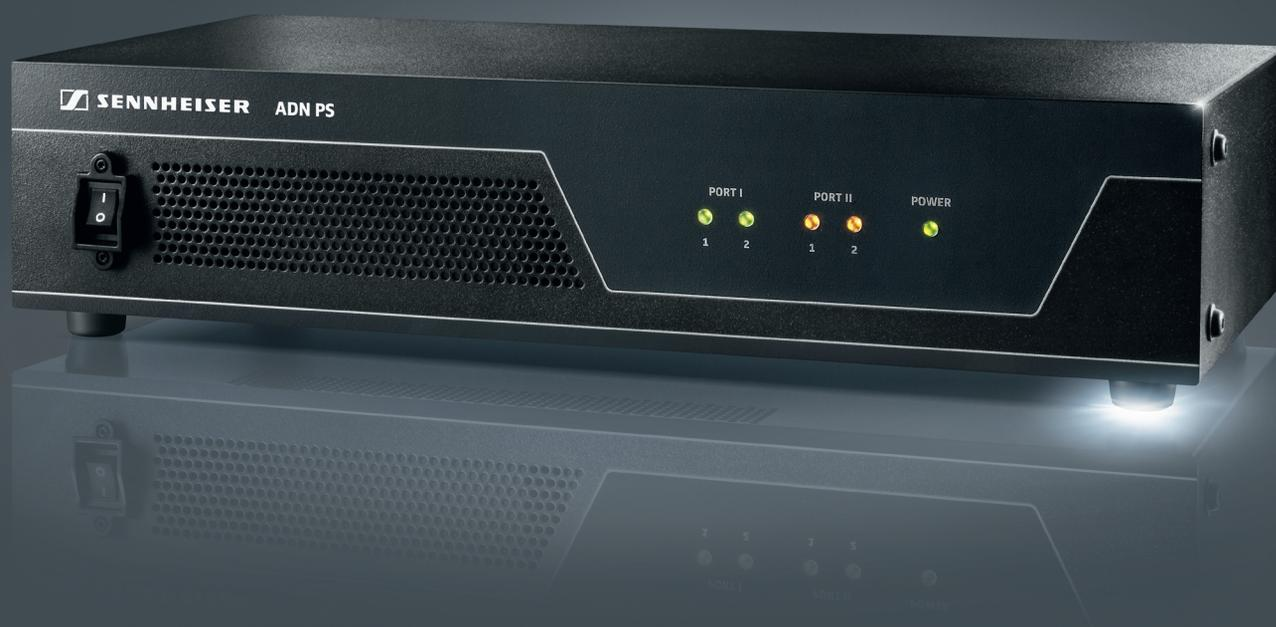
Каскадируемый источник питания ADN PS позволяет расширять систему до 400 участников. Он также увеличивает безотказность системы, обеспечивая резервное кольцевое соединение через два двойных коммутационных порта. Кольцами могут быть соединены до 40 конференц-пультов, соединением обычного типа — до 70 конференц-пультов.
