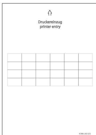
Маркировочные полоски PSK 0001 А подходят для следующих функциональных модулей: BCM 0000 А, LSN 0300 А, LSN 1500 А, CZM 0004 А, NZM0002 А, RMH 0002 А, СТМ 0002 А и ENO 0000 А. Полоски могут быть напечатаны отдельно на обычном лазерном принтере. На компакт-диске, поставляемом с контроллером панели МРС, имеется dot-файл.
