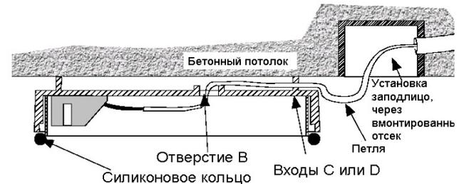
Рис. 5 разводка кабеля в сырых помещениях
