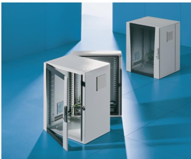
Универсальный настенный корпус **серии Rittal EL** отличается высокой механической прочностью и обладает высокой степенью защиты (IP 55). Он состоит из настенной части, поворотной средней части и передней обзорной двери. По комплектации различаются 3 версии шкафа EL: предварительно смонтированный, с монтажными шинами и с монтажной панелью. Предназначен для установки 19" оборудования либо оборудования на монтажную панель.
