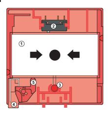
После разбития стекла (1), сигнализация включается кнопкой микропереключателя (2), выскакивая вперед, и индикатор светодиода(3) мигает.
