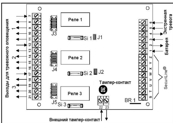
Рис. 3 Точки подключения и перемычки SOM 81
