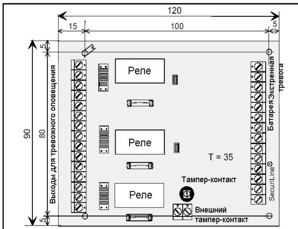
Рис. 2 Габариты SOM 81 (в мм)
